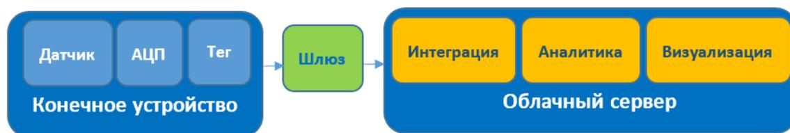
Рисунок 2 – Схема передачи информации с конечного устройства в облако
