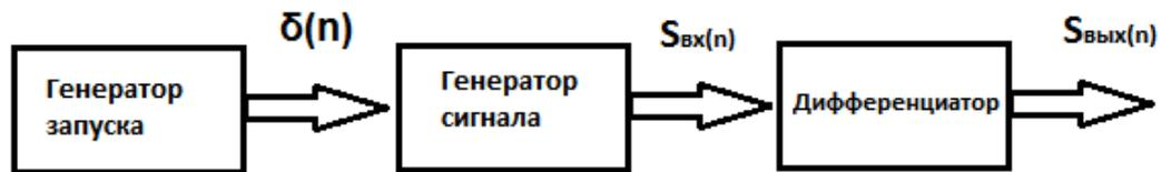
Рисунок 1 - Структурная схема исследования дифференцирования сигналов
