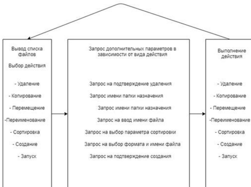
Рисунок 1. Блок-схема файлового менеджера
