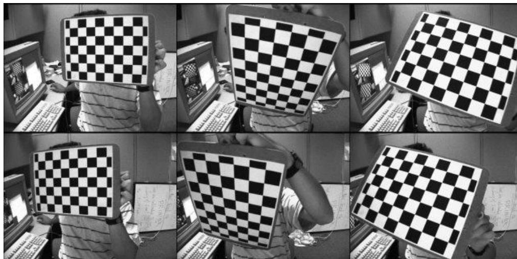
Рисунок 2. – Ручная калибровка камеры
