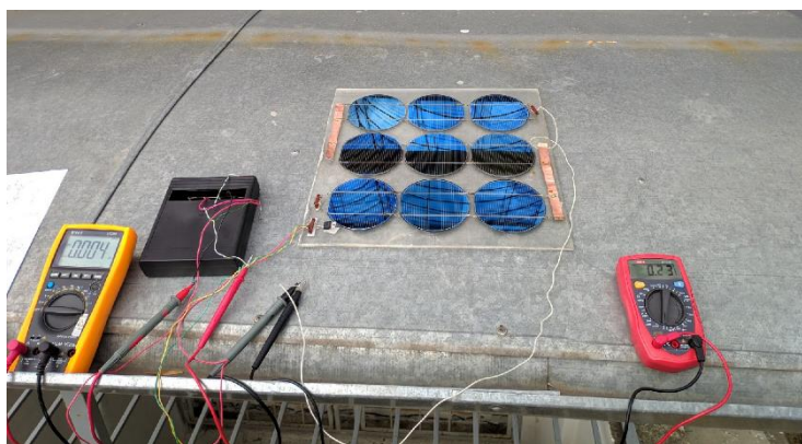
Рисунок 1 – Экспериментальный модуль автономной фотоэлектрической системы
