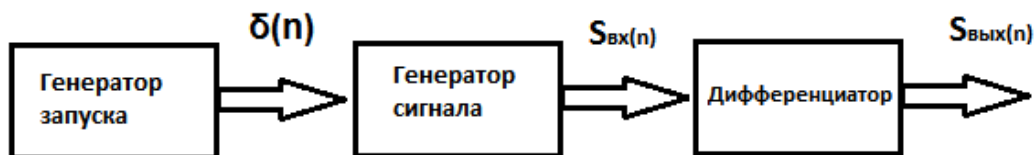
Рисунок 1 - Структурная схема исследования дифференцирования сигналов
