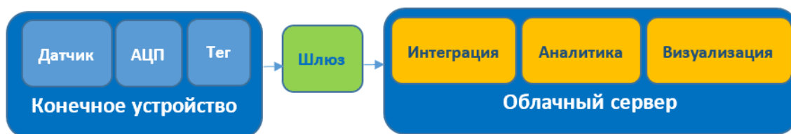
Рисунок 2 – Схема передачи информации с конечного устройства в облако
