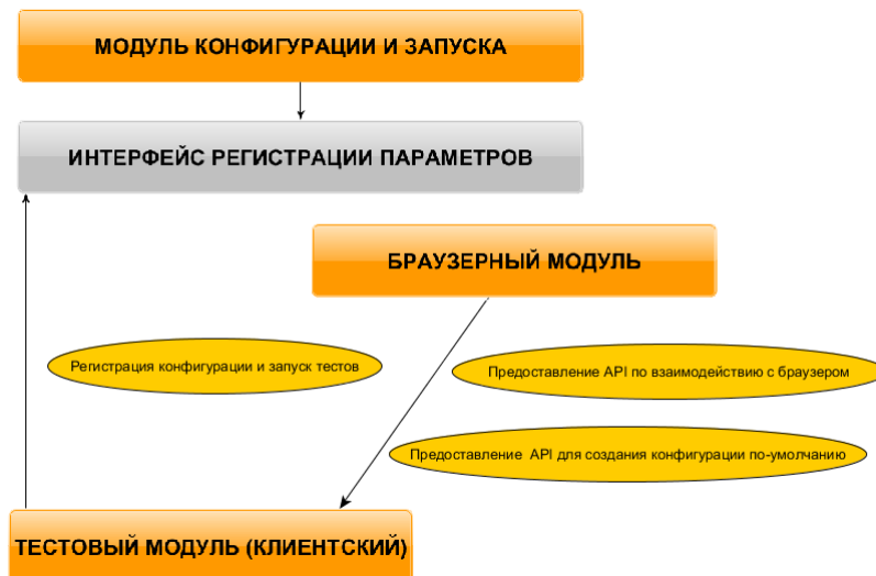
Рисунок 1 – Архитектура фреймворка автоматического тестирования программных приложений
