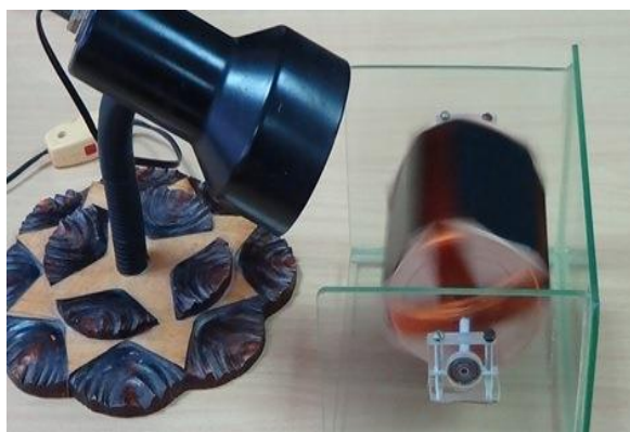
Рисунок 2- Модель бесколлекторного электрического двигателя на солнечных батареях
