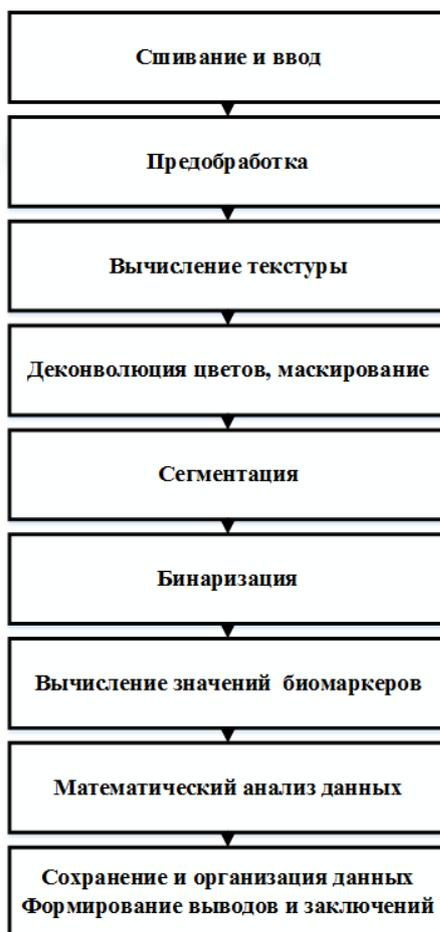
**Рисунок 7. – Общая схема конвейера обработки изображений**
