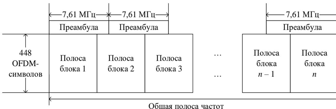
Рис. 3. Структура кадра системы DVB-C2
