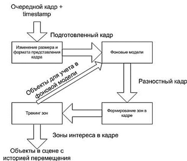
Рис. 1. Схема работы анализа видеопотока
