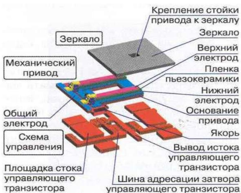
Рисунок 2.15. Конструкция ТМА - модулятора
