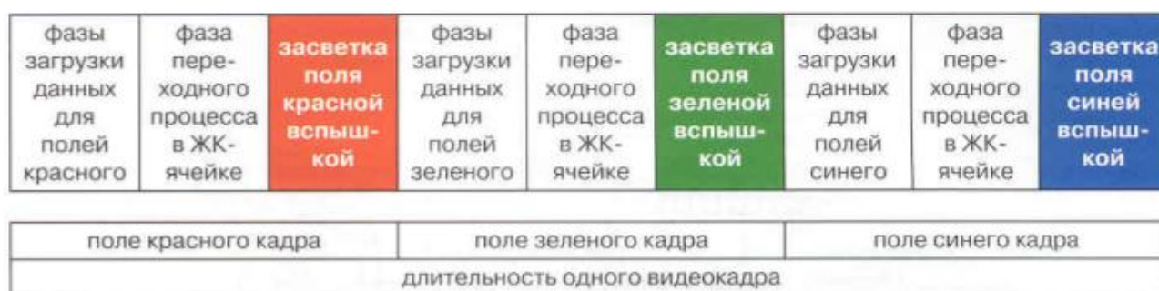
Рисунок 2.6. Диаграмма фаз состояния LCOS - микродисплея с динамической светодиодной подсветкой
