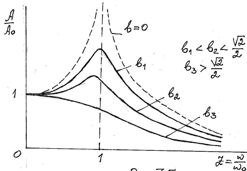
Частоту вынужденных колебаний, при которой в случае присутствия в системе сил сопротивления наступает резонанс, назовем *критической частотой*  $\omega_{кр}$ , значение которой определится из выражения:
