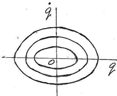
Эти кривые, зависящие от параметра  $A$ , называются *фазовыми траекториями*. Семейство фазовых траекторий зависит от амплитуды колебаний, которая, в свою очередь, определяется начальными условиями. Каждой фазовой траектории соответствует пара
