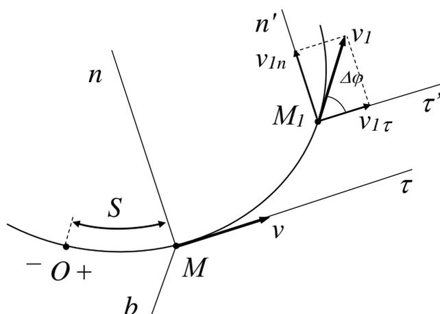
Для нахождения ускорения точки при естественном способе задания движения введем подвижную систему координат, называемую *естественным трехгранником*. Оси этой системы имеют начала, совпадающие с положением движущейся точки  $M$ , и направлены следующим образом
