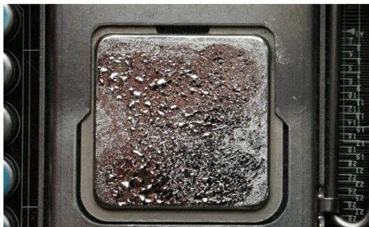
Рис 3. Нанесённый жидкий металл на крышку центрального процессора.
