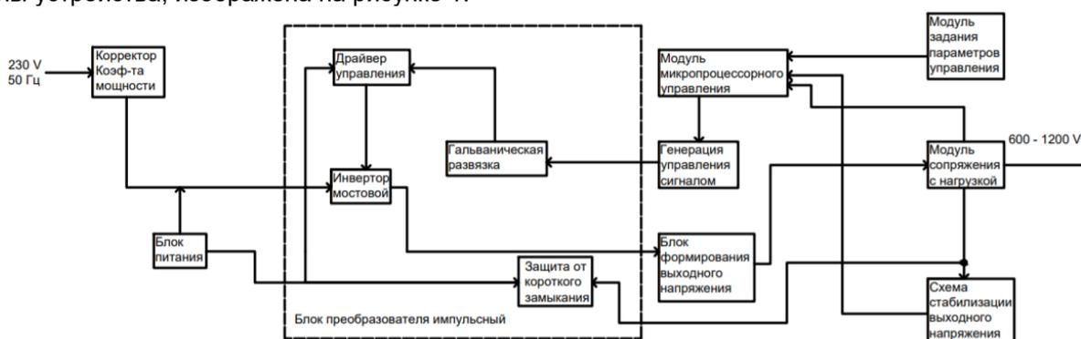
Рисунок 1 – Структурная схема одного канала импульсного источника питания.
