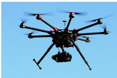
Рисунок 2 – Мультироторный вертолёт
