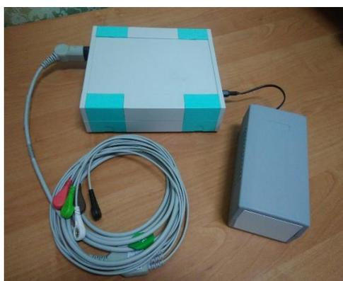
Рисунок 1 – двухканальный электромиограф
