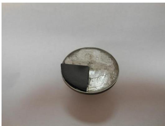
Рисунок 1– Внешний вид составной мишени SiO<sub>2</sub>/25 %C
