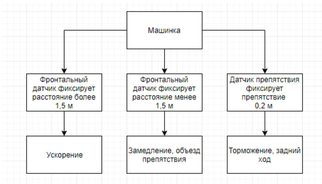
Рисунок 1 - Функциональная схема
