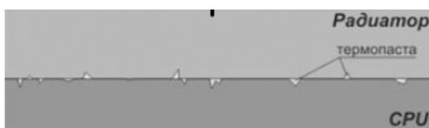
Рис 2. Заполнения микротрещин теплопроводящей пастой
