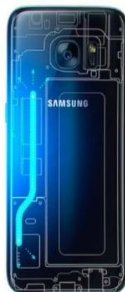
Рисунок 2 – Водяная система охлаждения смартфона «Galaxy S7»
