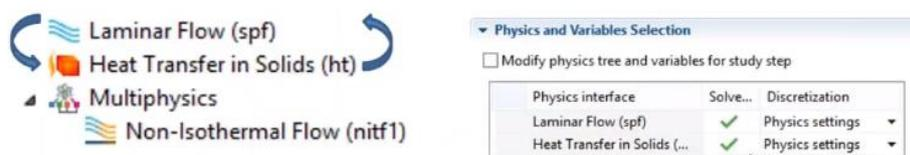
Рисунок 2 – Связь двух интерфейсов при сопряженном теплообмене
