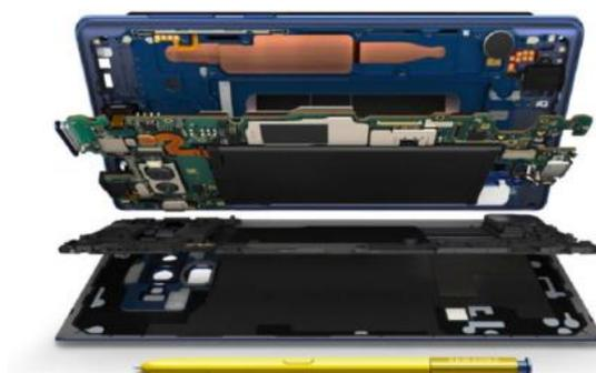
Рисунок 1 – Расположение системы водяного охлаждения в смартфоне
