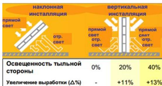
Рисунок 1 – Варианты инсталляции двусторонних модулей Sanyo и увеличение годовой выработки электроэнергии при различной освещенности тыльной стороны
