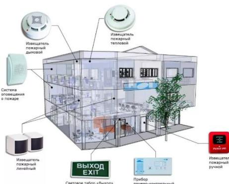
Рисунок 1 - Устройства пожарной безопасности в здании
