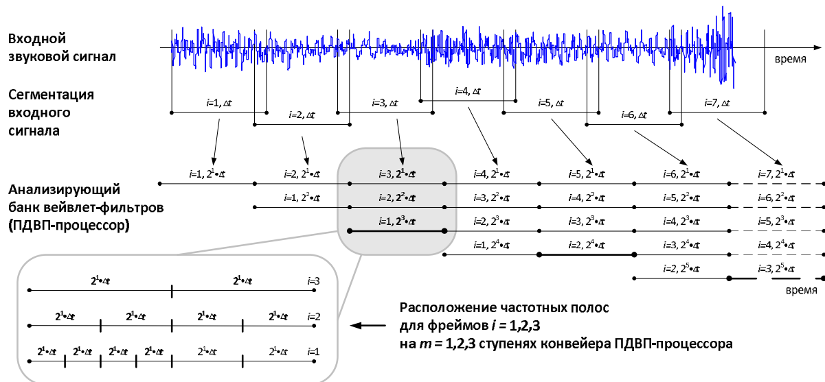
Рис. 18.27 – Схема анализа входного сигнала в ПДВП процессоре
