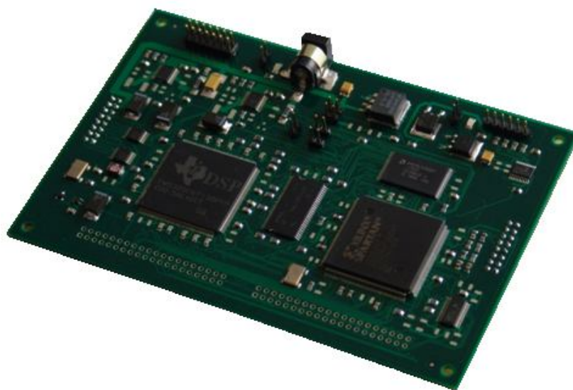
Рис. 18.3 – Вычислительная платформа с реконфигурируемой логикой для мультимедиа приложений реального времени
