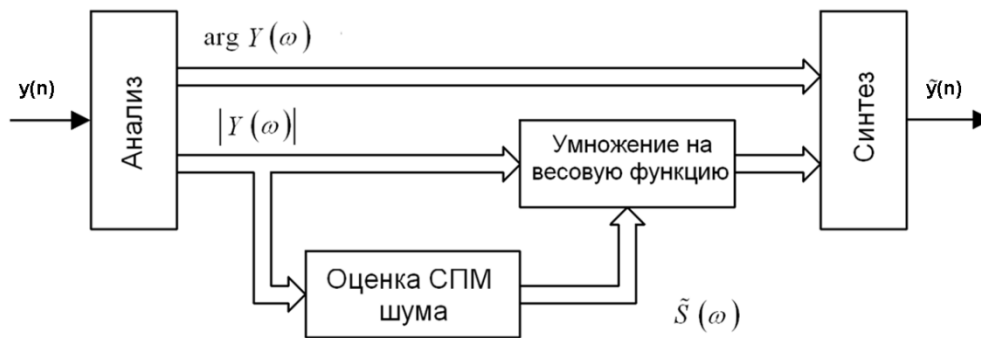
Рис. 14.4 – Схема подавления шума на основе спектрального взвешивания
