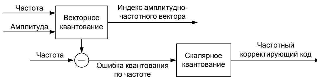
Рис. 10.18 – Схема коррекции частоты
