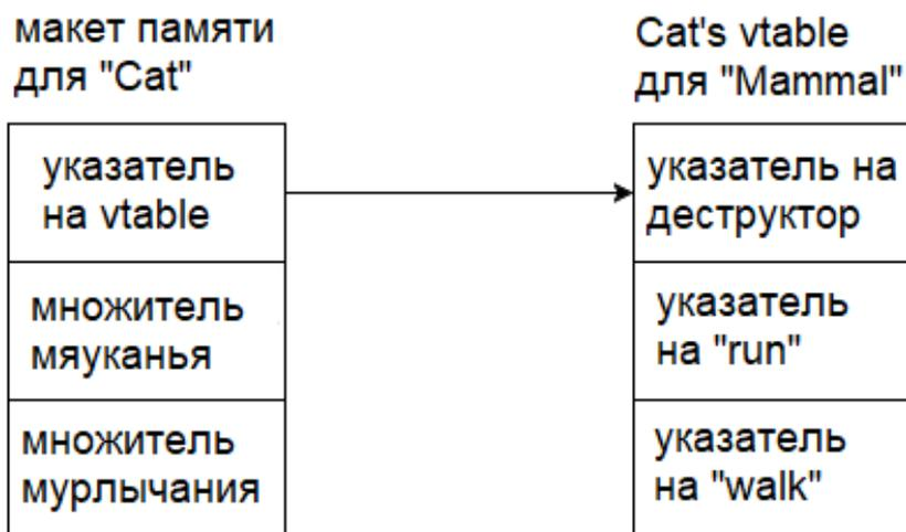
Рисунок 1 – Пример виртуальной таблицы методов для “Cat”
