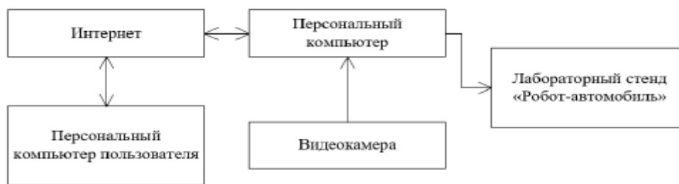
Рисунок 1 – Структурная схема системы удаленного доступа к лабораторному оборудованию
