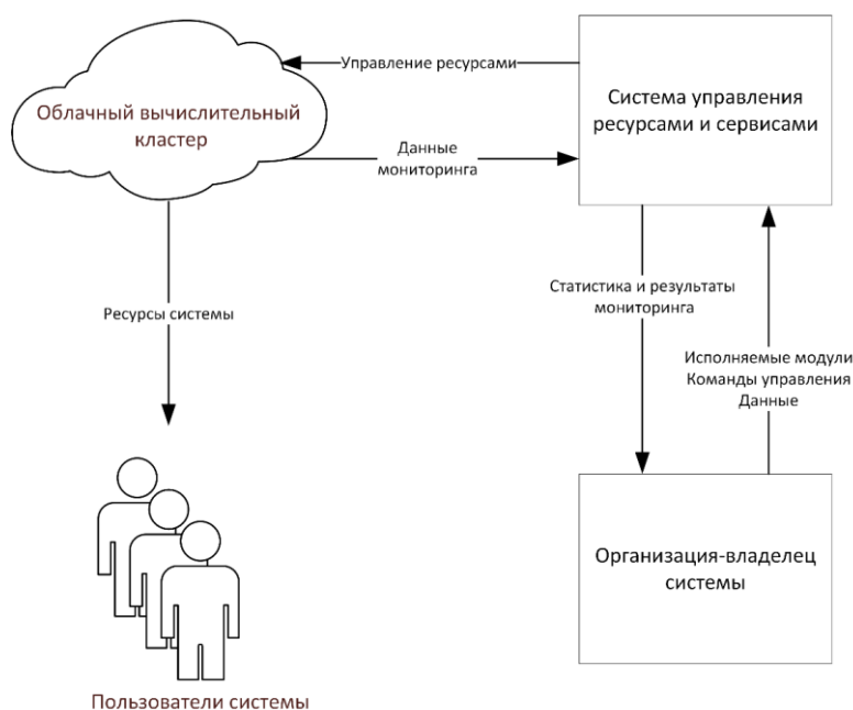
Рисунок 1 – Общая схема функционирования сетевого приложения с использованием облачных вычислений.
