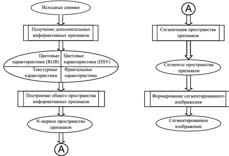
Рис. 4. Схема алгоритма сегментации с использованием дополнительных признаков
