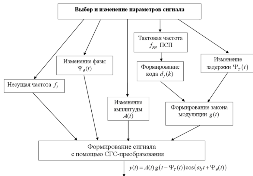
Рис. 3. Схема формирования сигнала с динамически изменяемой структурой
