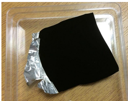
Рис. 4. – Кусок алюминиевой фольги, покрытый Vantablack
