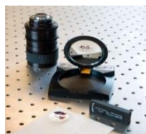
Рис. 2 - Традиционный объектив(слева) и три модели «оригами-объективов»
