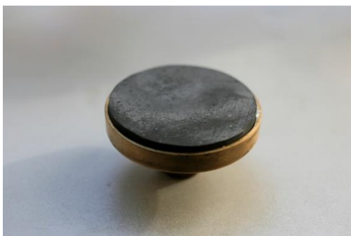
Рис.1.– Внешний вид мишени из высокоплотного графита
