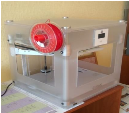
Рис. 1 – Новое крепление для подачи пластика
