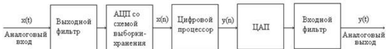
Упрощенная схема цифрового фильтра реального времени с аналоговым входом и выходом
