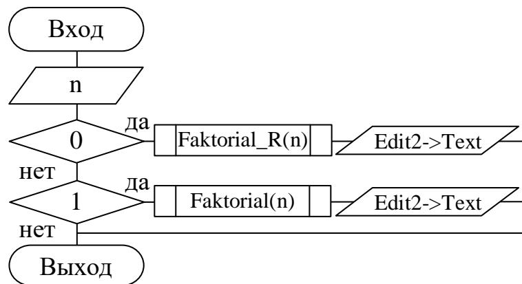
Рис. 1.1. Блок – схема вызова рекурсивной и нерекурсивной функции
