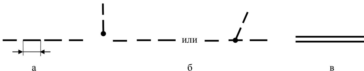
Рисунок 3.3 – Обозначение линий механической связи (к пункту 3.2.10)
