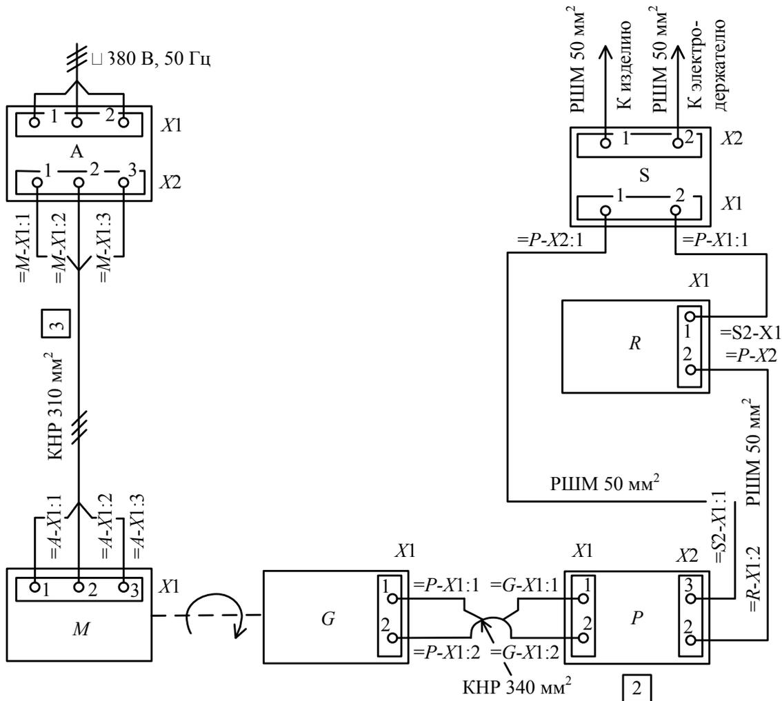
Рисунок 3.35 – Пример выполнения схемы подключения электрического насоса
