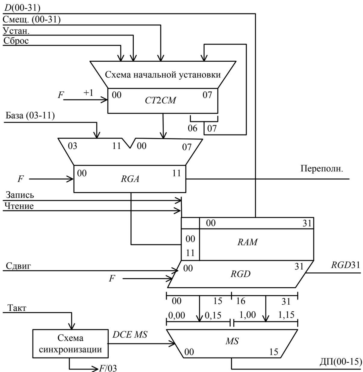
Рисунок 3.42 – Фрагмент схемы электрической функциональной цифрового устройства
