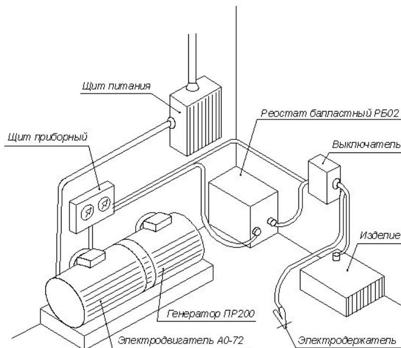
Рисунок 3.37 – Схема электрическая расположения электросварочного поста
