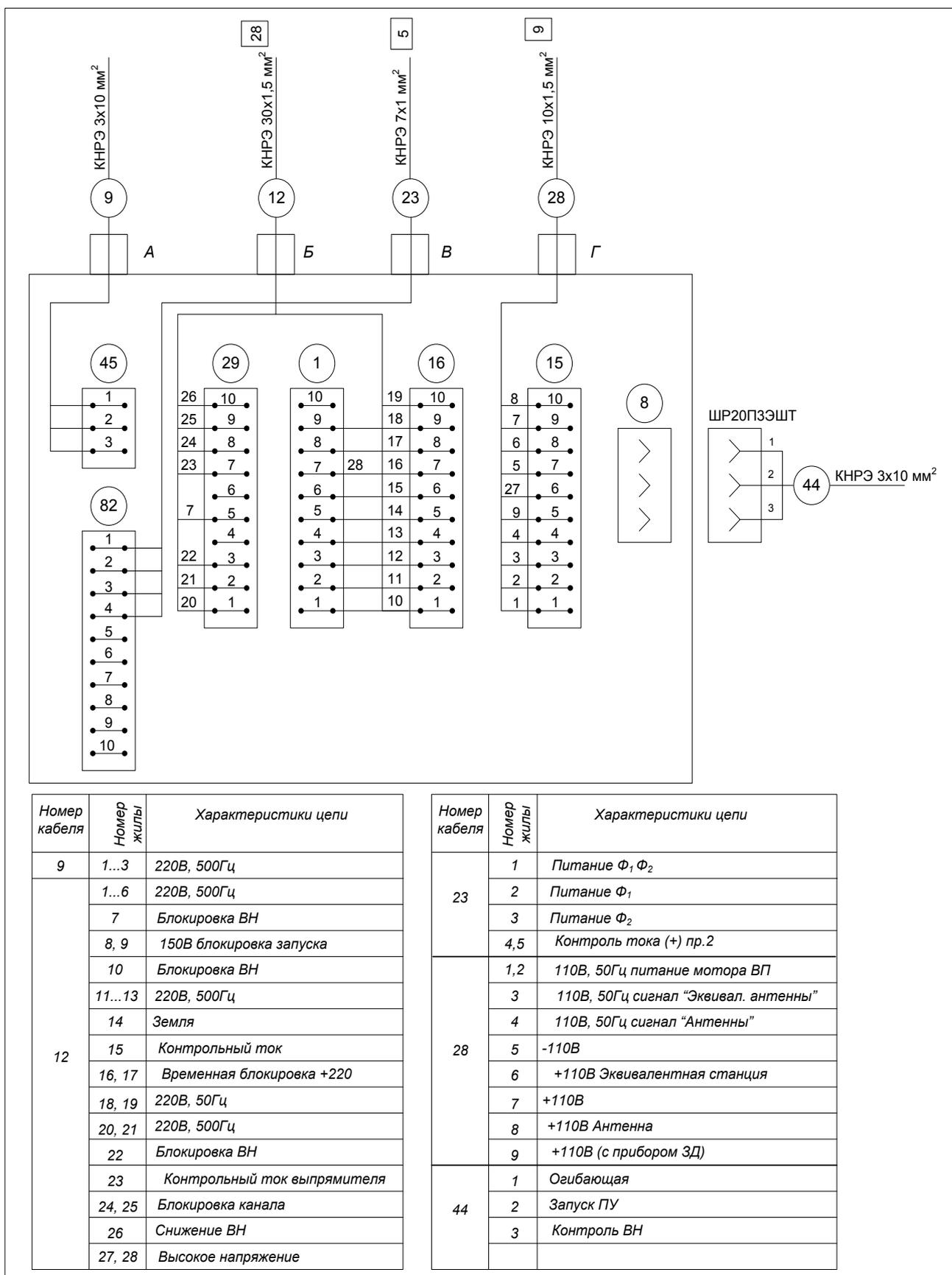
Рисунок 3.36 – Схема подключения с таблицей характеристик цепей
