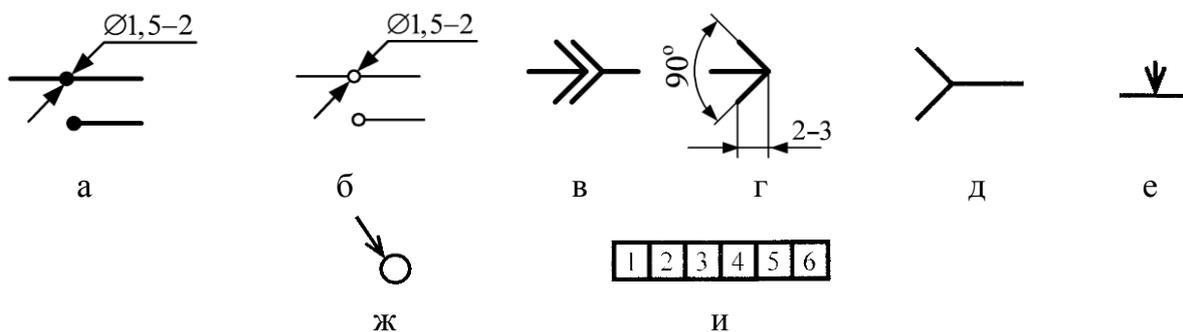
Рисунок 3.7 – Условные графические обозначения контактных соединений (к пункту 3.3.3)
