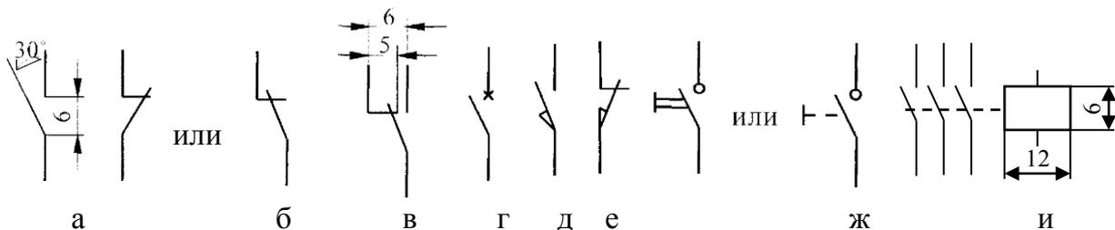
Рисунок 3.6 – Условные графические обозначения коммутирующих устройств (к пункту 3.3.2)
