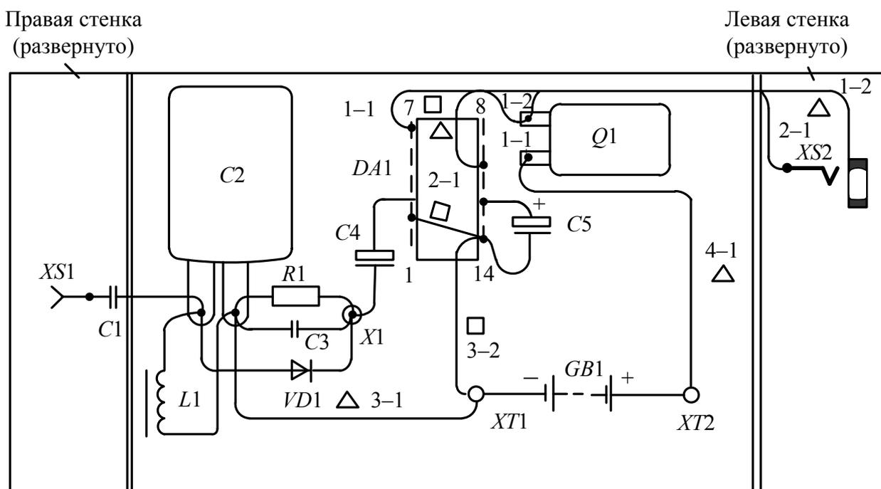
Рисунок 3.34 – Пример выполнения схемы соединений (Э4)
