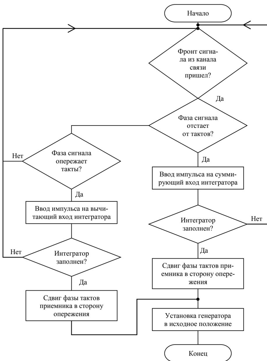
Рисунок 3.33 – Схема алгоритма работы устройства
