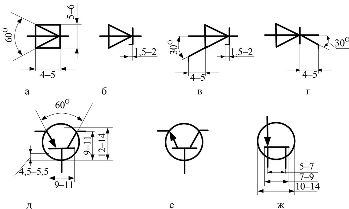
Рисунок 3.10 – Условные графические обозначения полупроводниковых приборов (к пункту 3.3.7)
