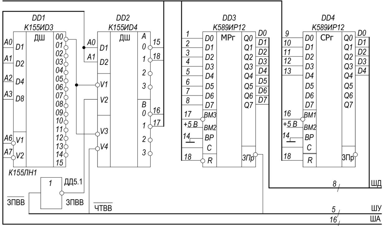
Рисунок 3.41 – Схема электрическая функциональная блока дешифраторов
