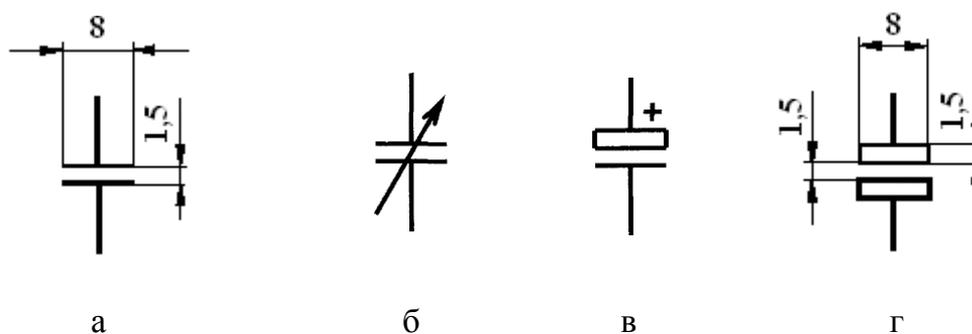
Рисунок 3.9 – Условные графические обозначения конденсаторов (к пункту 3.3.6)
