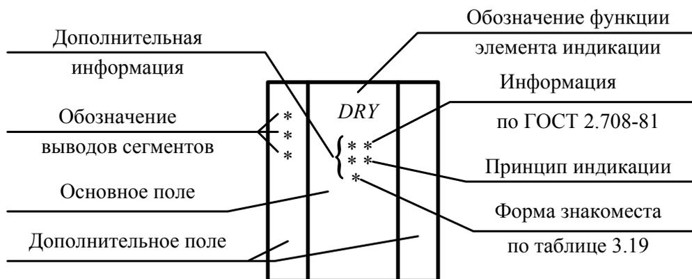
Рисунок 3.17 – Условное графическое обозначение интегрального оптоэлектронного элемента индикации
