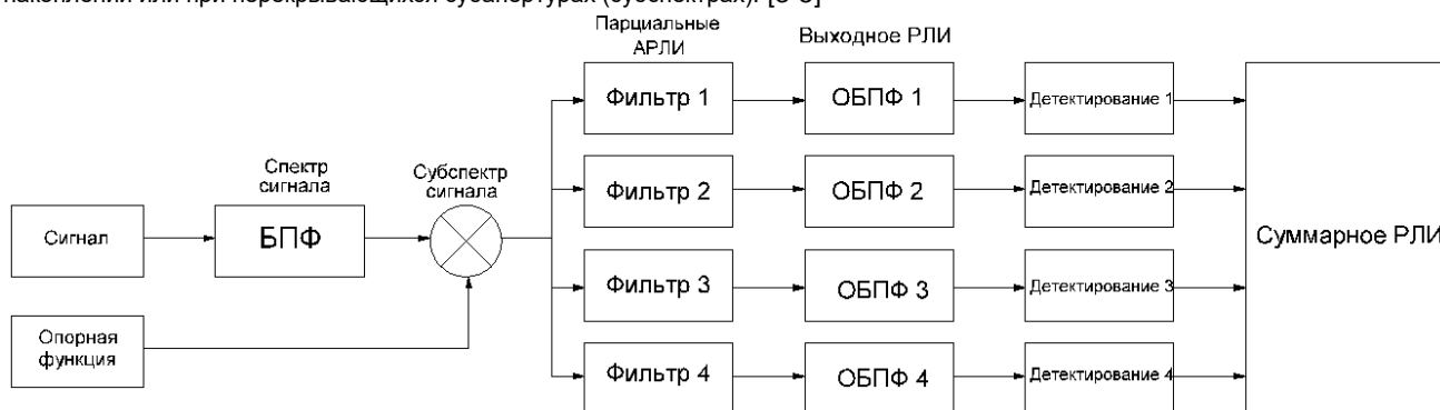
Рисунок 1 – Структурная схема внутриэлементного некогерентного накопления
