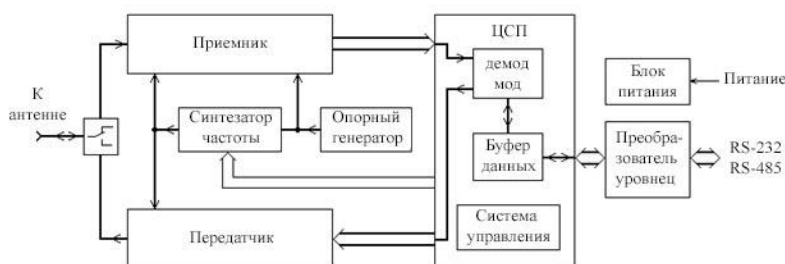
Рис. 1 – Структурная схема радиомодема передачи данных
