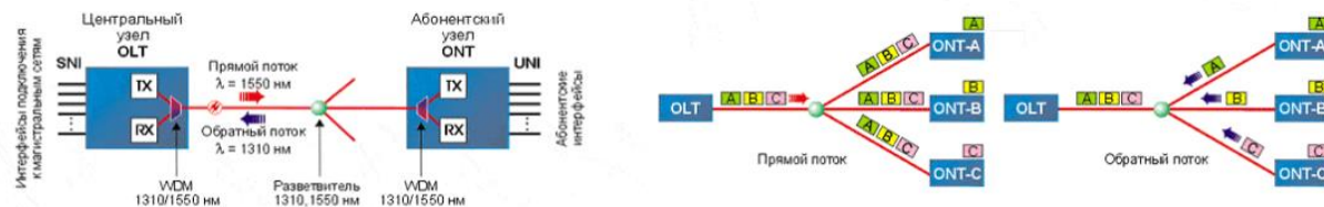
Рис.1 - Основные элементы архитектуры PON и принцип их действия
