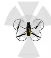
Рис. 2 – Схема расположения УЗ-датчиков
