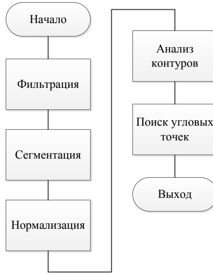
Рис. 2. Блок-схема углового масочного детектора
