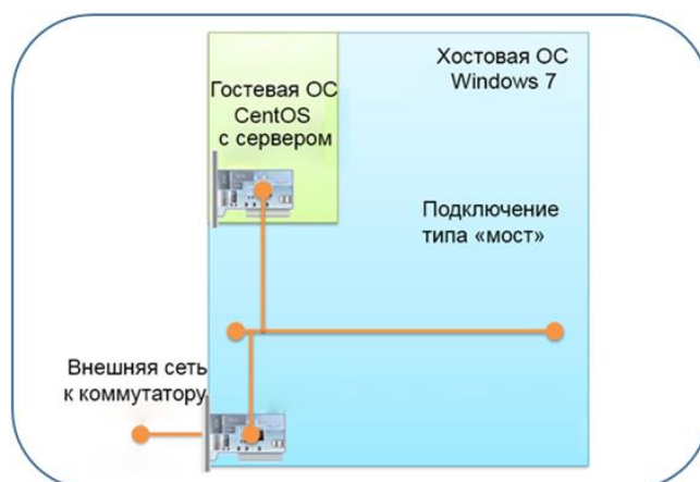
Рис. 4. Подключение сервера к локальной сети
