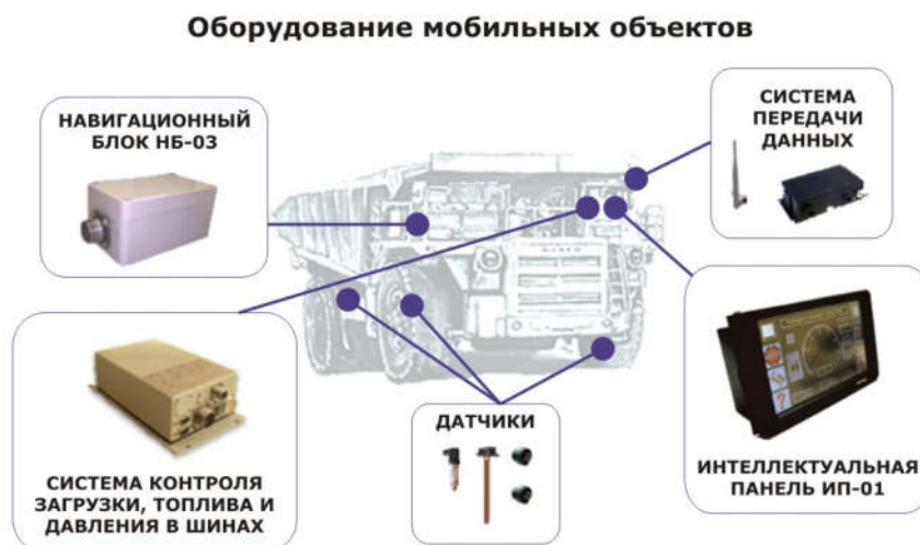
Рис. 2. Состав оборудования мобильных объектов [2].
