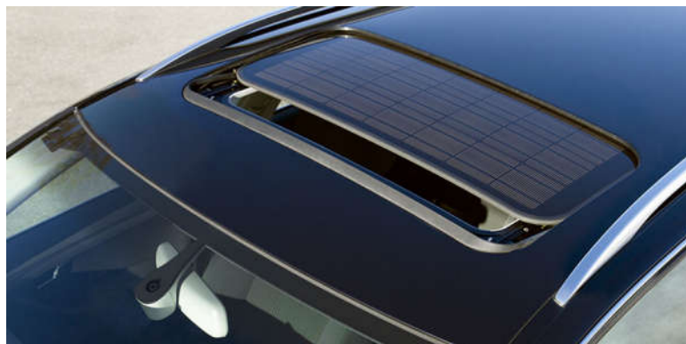
Рисунок 2 – Автомобильный люк с тонкоплёночной солнечной батареей
