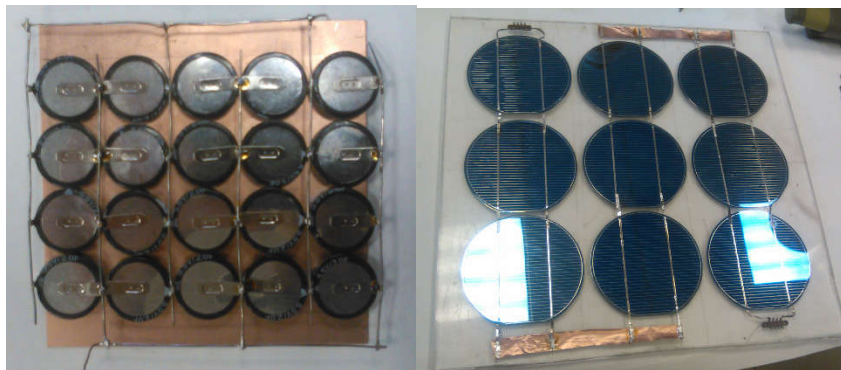
Рис. 3 - Основные элементы лабораторного макета, батарея суперконденсаторов (слева) и фотоэлектрический преобразователь (справа)
