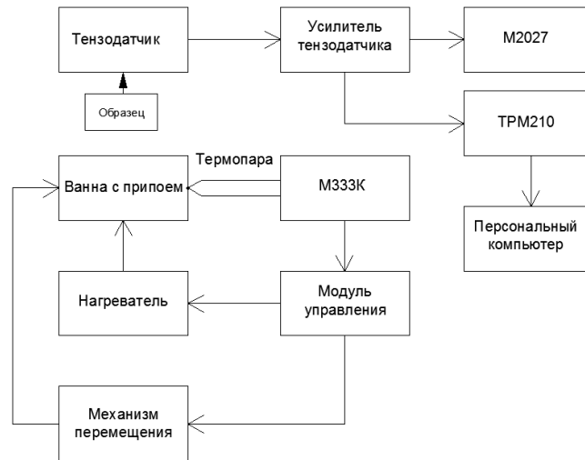
Рис. 1. Схема устройства для контроля паяемости гальванических покрытий методом измерения силы смачивания
