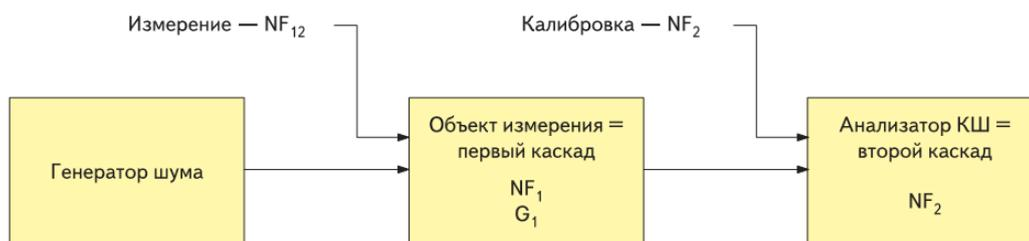
Рис.3 – Структурная схема включения объекта измерения для измерения коэффициента шума
