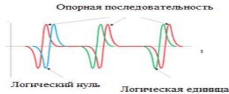
Рисунок 1.1 – Фазоимпульсная модуляция
