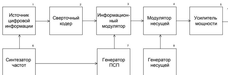
Источник цифровых импульсов (ИЦИ) формирует из аналогового сигнала цифровую последовательность импульсов. Кодер предназначен для преобразования исходного информационного сигнала в выходной кодированный сигнал. Информационный модулятор (ИМ) представляет собой устройство, предназначенное для формирования широкополосного сигнала.
