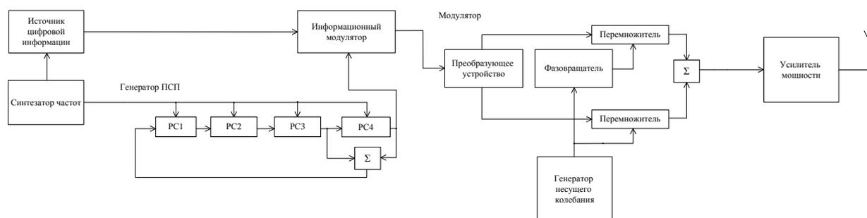
Рис. 1 – Функциональная схема передатчика
