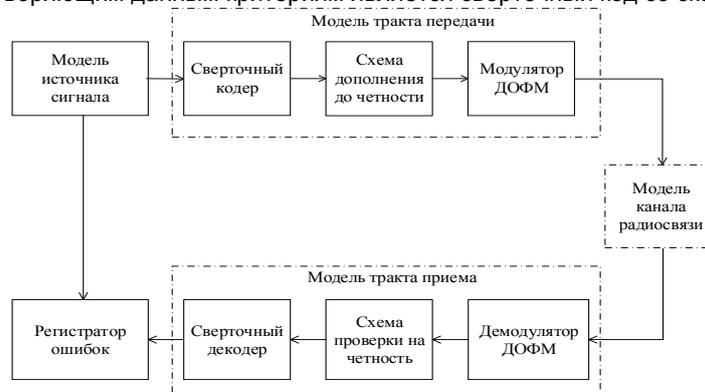
Рисунок 1.2 – Структурная схема модели одноканальной системы радиосвязи с включением в состав изделия АТ3004Д сверточного кода
