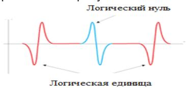
Рисунок 1.3 – Двухпозиционнофазовая модуляция
