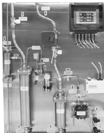
Рис. 2. Пример УПП с двухконтурным охлаждением и системой стабилизации температуры пробы
