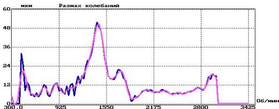
Рис. 5. Аппроксимация вибрационной характеристики выбега
