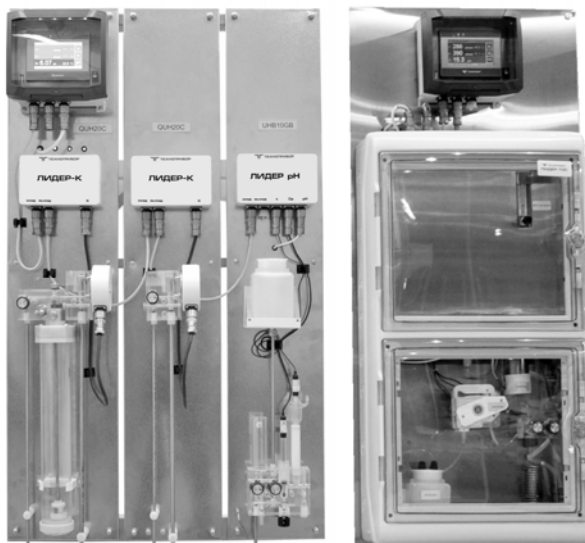
Рис 3. Система «ЛИДЕР» с двумя кондуктометрическими каналами (ЛИДЕР-К) и каналом рН (ЛИДЕР-рН) (слева) и система «ЛИДЕР» с каналом общего органического углерода (ЛИДЕР-ТОС) (справа)
