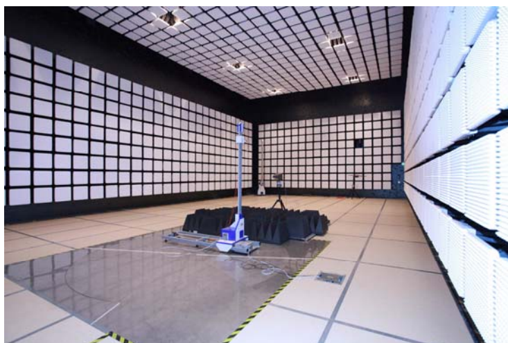
Рис. 1. Вид полубезэховой экранированной камеры с 10 метровой испытательной базой для диапазона частот от 10 кГц до 40 ГГц
