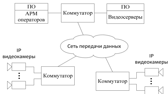
Рис. 1. Структурная схема IP системы видеонаблюдения
