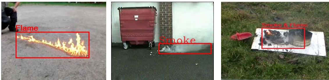
Рис. 1. Примеры детектирования дыма и пламени гибридным алгоритмом
