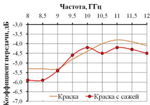
Рис. 1. Частотные зависимости коэффициента передачи огнестойкой краски
