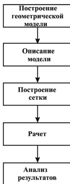
Рис. 1. Методика расчета теплового поля средств тепловой защиты
