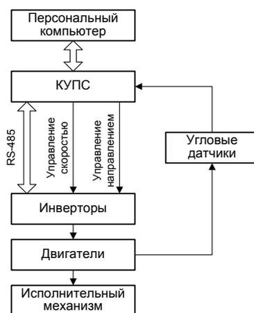
Рис. 1. Конфигурационная структура симулятора пространственных движений
