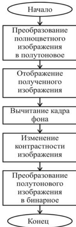
Рис. 1. Алгоритм предварительной цветовой обработки видеок кадров
