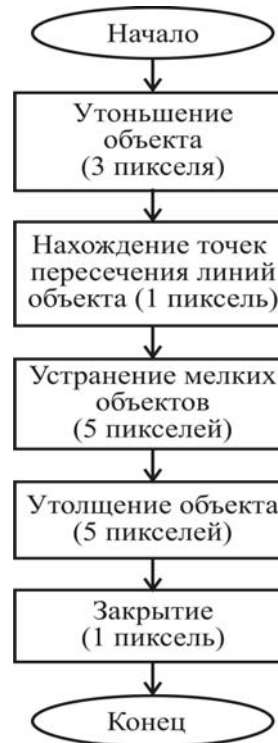
Рис. 2. Алгоритм морфологической обработки бинарного изображения
