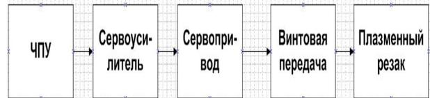
Рис. 2 – Структурная схема системы плазменной резки
