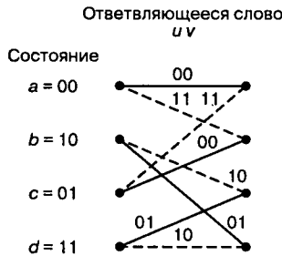
Рис. 8.25б. Решетчатая структура RSC-кода, представленного на рис. 8.25, а
