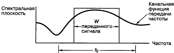
б) Типичный случай амплитудного замирания ( f_0 > W )
