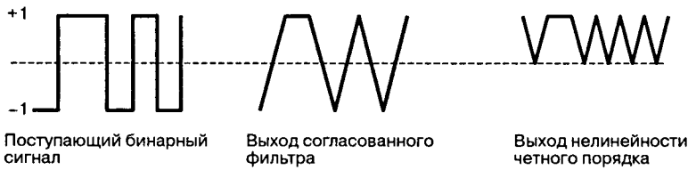
Рис. 10.12. Иллюстрация процессов, проходящих в размыкнутом битовом синхронизаторе
