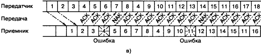
Рис. 6.7. Автоматический запрос повторной передачи (ARQ): а) запрос ARQ с остановками (полудуплексная связь); б) непрерывный запрос ARQ с возвратом (полнодуплексная связь); в) непрерывный запрос ARQ с выборочным повторением (полнодуплексная связь)
