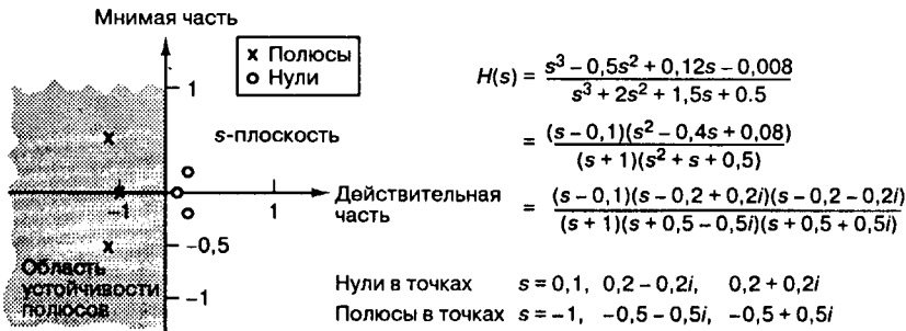
Рис. Д.2. Нули и полюса передаточной функции, изображенные в s -области
