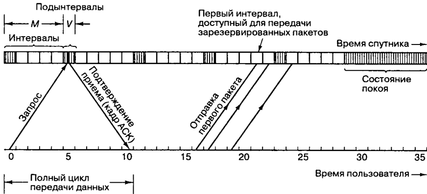
Рис. 11.22. Пример алгоритма ALOHA с использованием резервирования. Передающая станция резервирует три интервала ( M = 5 интервалов, V = 6 подынтервалов)
