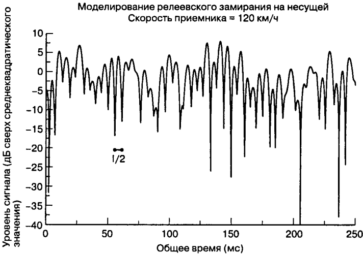
Рис. 15.12. Типичный профиль огибающей при релейском замирании на частоте 900 МГц. (Rappaport T. S. Wireless Communications . Chapter 4, Prentice-Hall, Upper Saddle River, New Jersey, 1996.)
