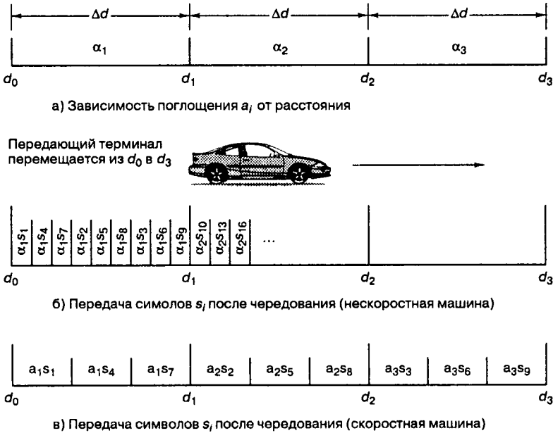
Рис. 15.20. Преимущества чередования при увеличении скорости радиостанции
