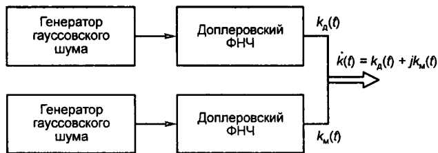
Рис. 8.9. Имитатор канала с гладкими замираниями
