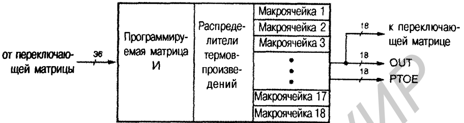
Рис. 10.39. Архитектура функционального блока
