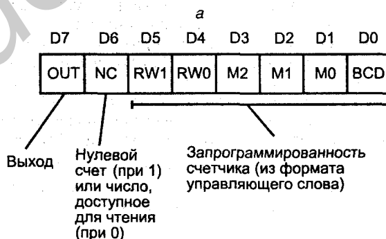
Рис. 6.42. Форматы управляющего слова (а) и слова состояния (б) интервального таймера
