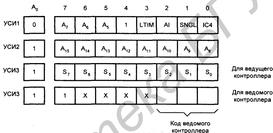
Рис. 6.28. Форматы управляющих слов инициализации программируемого контроллера прерываний
