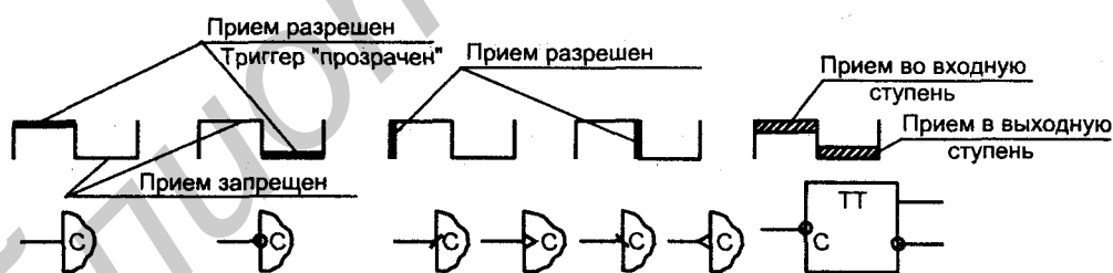
Рис. 3.3. Временные диаграммы, поясняющие работу синхронных триггеров, и условные обозначения тактирующих входов
