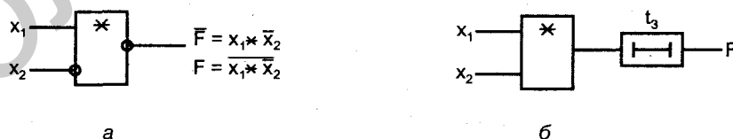
Рис. 1.1. Обозначение идеализированного логического элемента ( а ) и модель логического элемента с фиксированной задержкой ( б )
