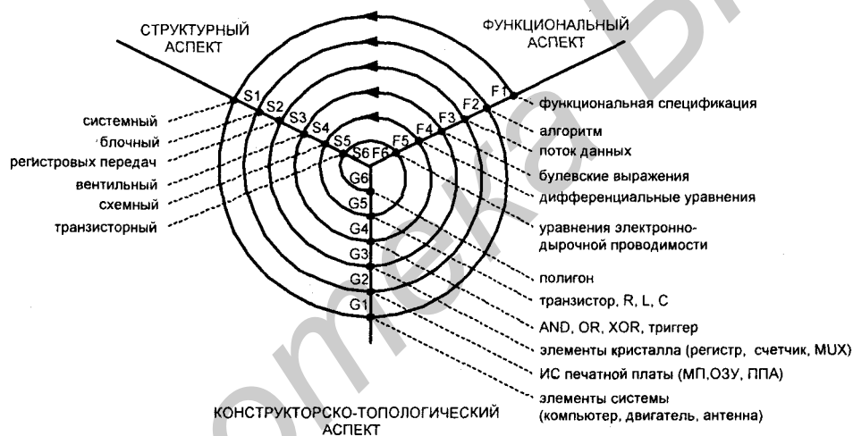
Рис. 12.1. Многоаспектное и многоуровневое отображение процедуры проектирования
