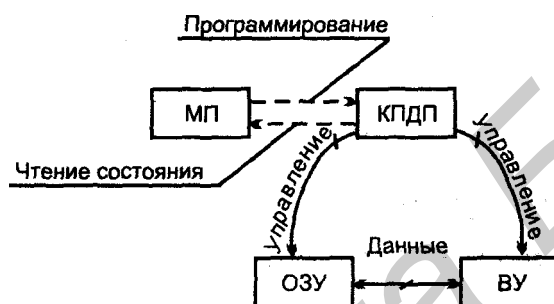
Рис. 6.32. Схема взаимодействия блоков микропроцессорной системы при прямом доступе к памяти
