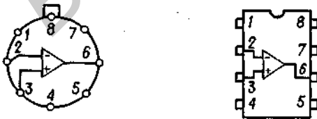
Рис. 6.6. Схема присоединения операционного усилителя типа 741 (вид сверху).
