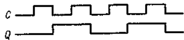
Рис. 9.31. Временная диаграмма триггера типа М-S при введении обратной связи R = Q и S = \bar{Q} (счетный триггер).
