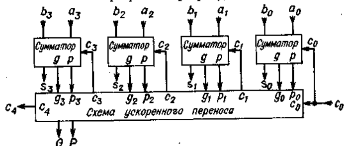
Рис. 19.29. Четырехразрядный сумматор с параллельным переносом.
