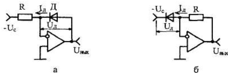
Рис. 1.22. Усилитель с логарифмической (а) и антилогарифмической (б) передаточной функцией
