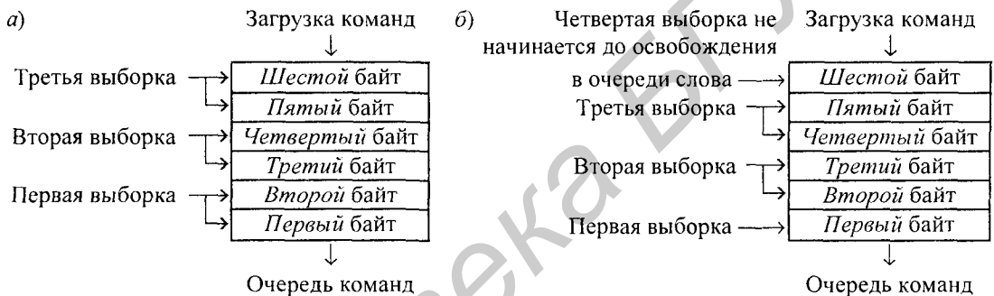
Рис. 4.16. Заполнение очереди команд после перехода на четный (а) и нечетный (б) адреса
