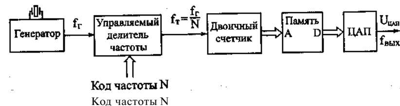
Рис. 8.19. Опрос памяти с помощью двоичного счетчика.
