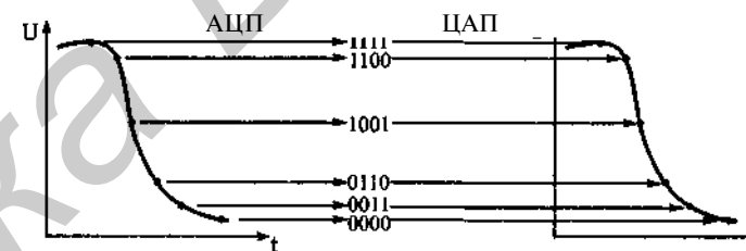
Рис. 1.24. Аналого-цифровое и цифро-аналоговое преобразование.
