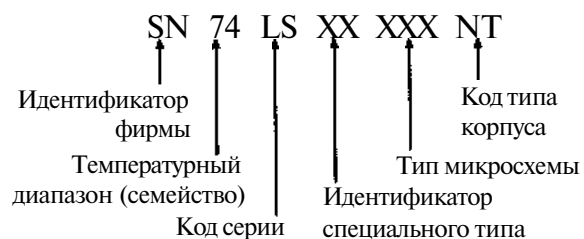
Рис. 1.17. Система обозначений фирмы Texas Instruments.
