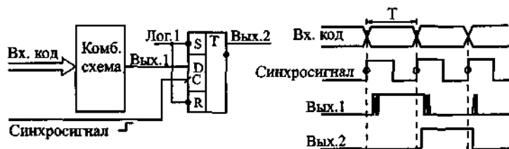
Рис. 4.9. Синхронизация с помощью триггера при периодическом изменении входного кода.
