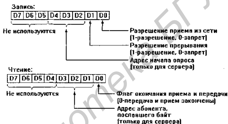
Рис. 4.9. Формат управляющего слова сети типа «звезда»
