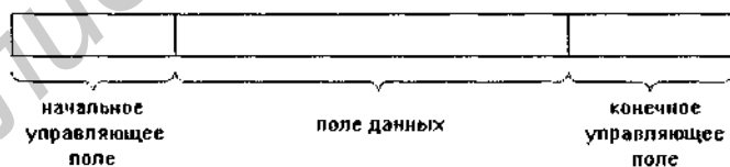
Рис. 1.20. Три поля сетевого пакета
