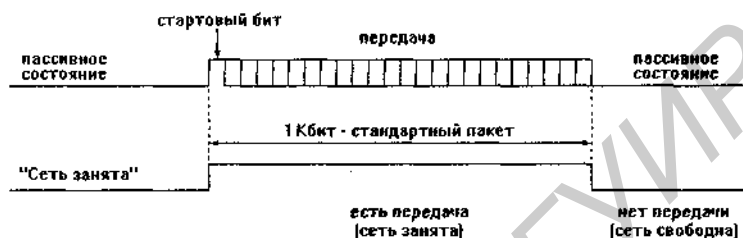
Рис. 1.26. Определение занятости сети при использовании кода NRZ
