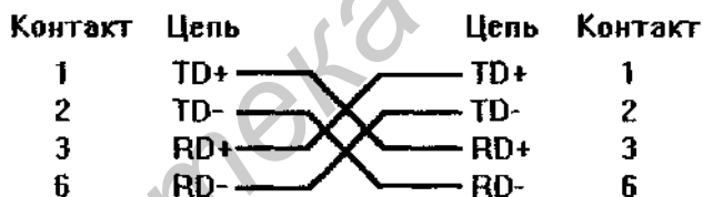
Рис. 3.9. Схема соединений в «перекрестном» кабеле
