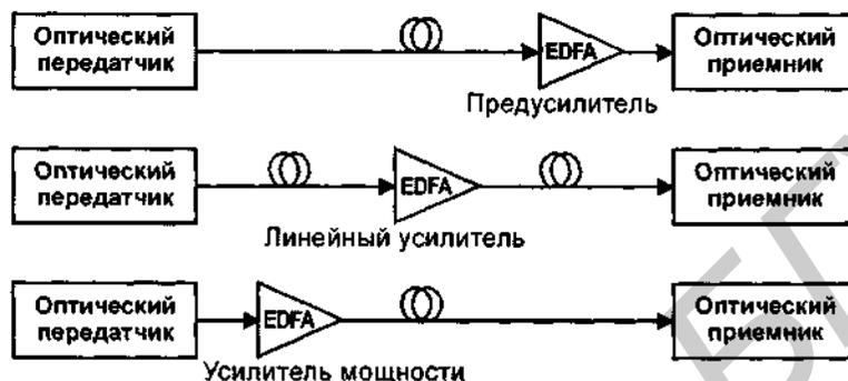
Рис. 8.6. Применение разных типов оптических усилителей
