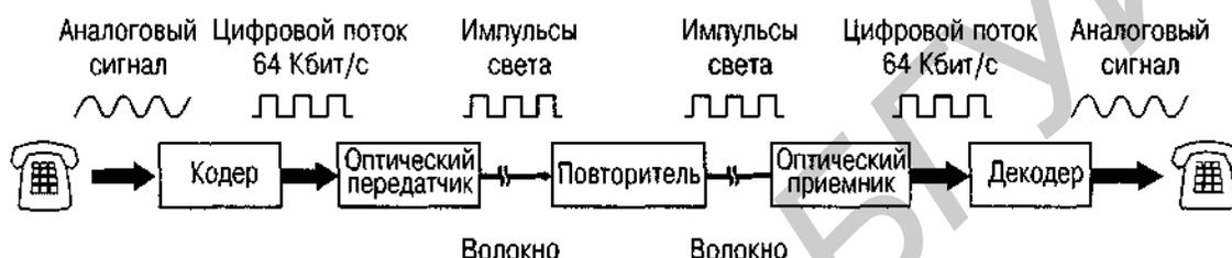
Рис. 1.1. Типовая схема системы связи с использованием ВОЛС "точка-точка"
