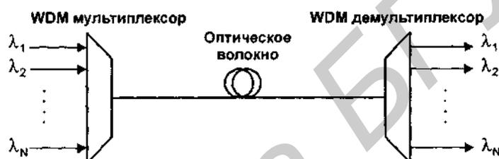
Рис. 3.14. Схема оптического сегмента, использующего передачу мультиплексного сигнала по волокну
