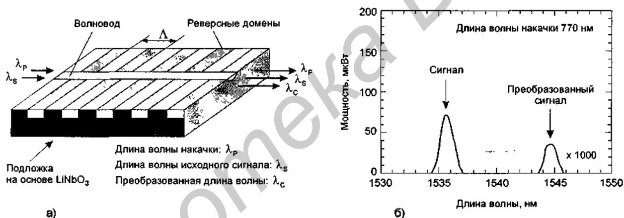
**Рис. 8.15.** Схема и профили мощности волнового конвертера: а) схема волнового конвертера с периодической ферроэлектрической структурой; б) профили мощности входного и выходного сигналов (по материалам фирмы OKI Electric Industry [21])
