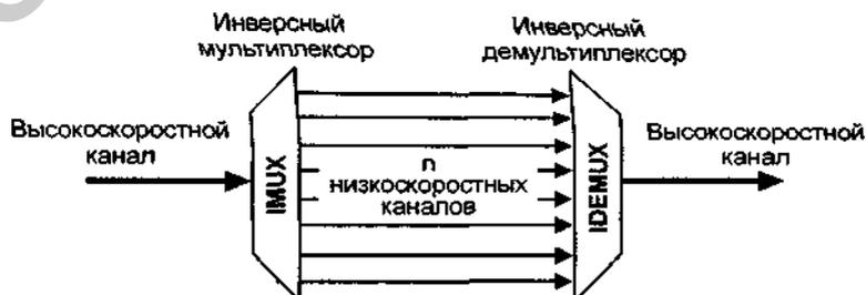
Рис. 5.8. Инверсный мультиплексор
