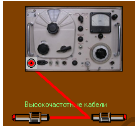
Рисунок 1.19 – Внешний вид подключённого к генератору кабеля
