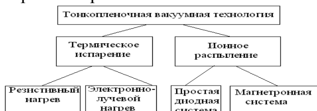
Рис. 7.1. Основные технологические способы испарения материалов в вакууме 7.1. Термическое испарение материалов в вакууме
