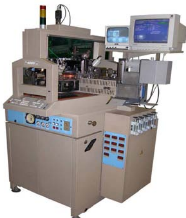
Рис. 11.13 Автомат присоединения кристаллов ЭМ–4085–14М
