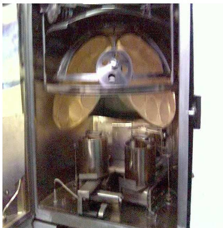
Рис. 7.15. Вид подколпачного устройства установки УВНРЭ– Э60.
