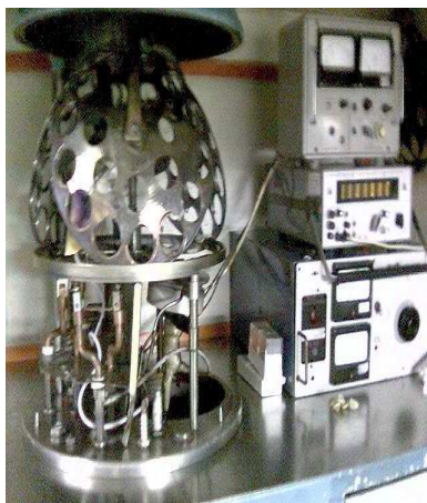
Рис. 7.10. Внешний вид подколпачного устройства установки УРМ–3.279.017
