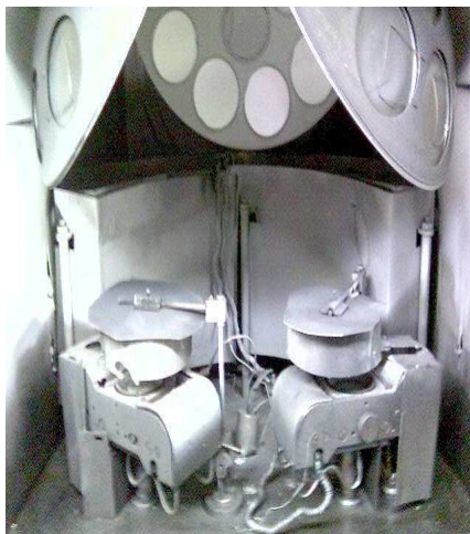
Рис. 7.12. Внешний вид подколпачного устройства установки «Оратория–9»
