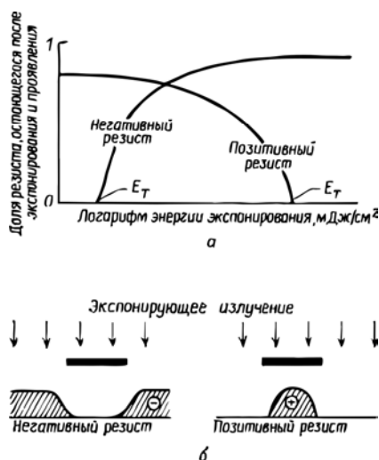
Рис. 8.3. Экспонирование фоторезистов
