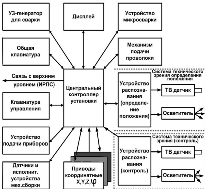
Рис. 12.3. Структурная схема установки УЗС проволочных выводов
