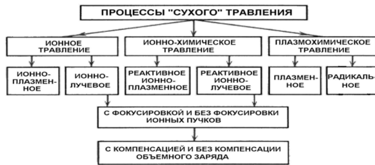
Рис. 4.1. Классификация процессов ионно–плазменного травления
