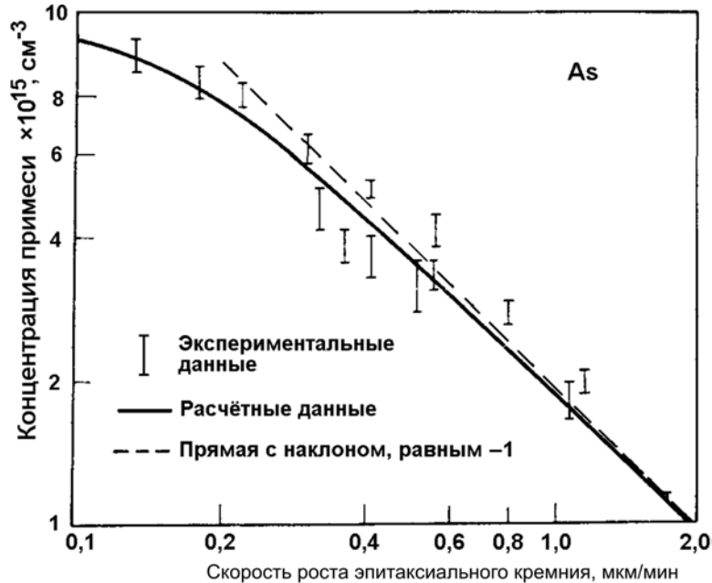
Рис. 5.8. Влияние скорости роста на концентрацию легирующей примеси (As) в эпитаксиальном слое
