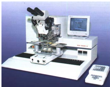
Рис. 11.9. Установка присоединения кристаллов ЭМ–4025АМ
