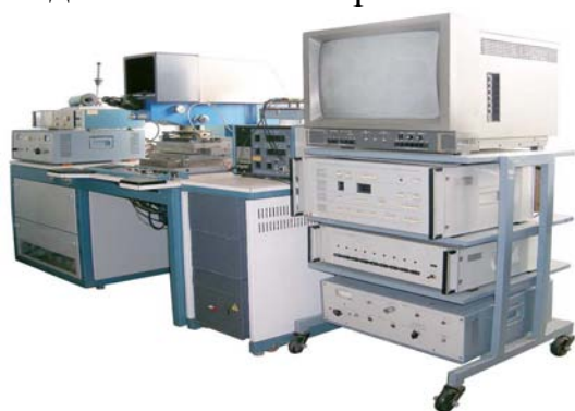
Рис. 11.15. Лазерный фотоакустический комплекс неразрушающего контроля
