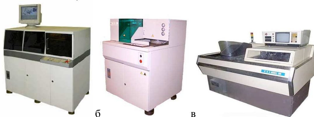
Рис. 11.8 . Автоматизированные установки разделения пластин: а – ЭМ–2055, б – ЭМ–2085, в – К&S 918
