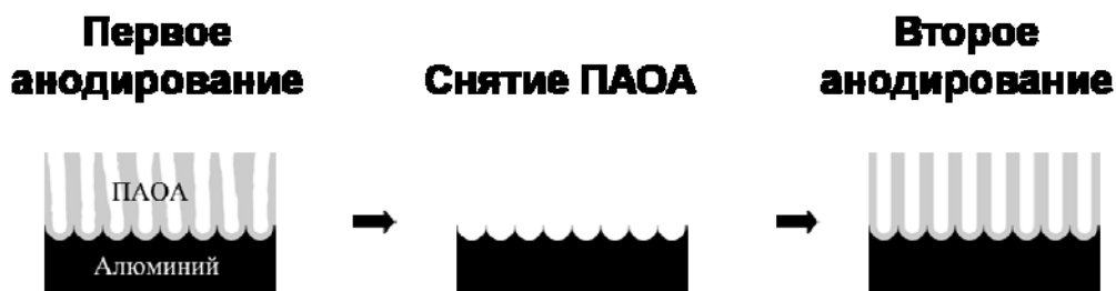
Рис. 3.1 – Основные стадии процесса создания высокоупорядоченного анодного оксида алюминия
