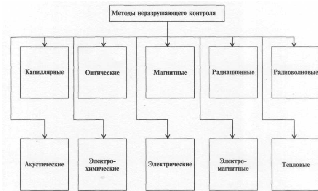
Рисунок 3.2 – Классификация методов неразрушающего контроля.
