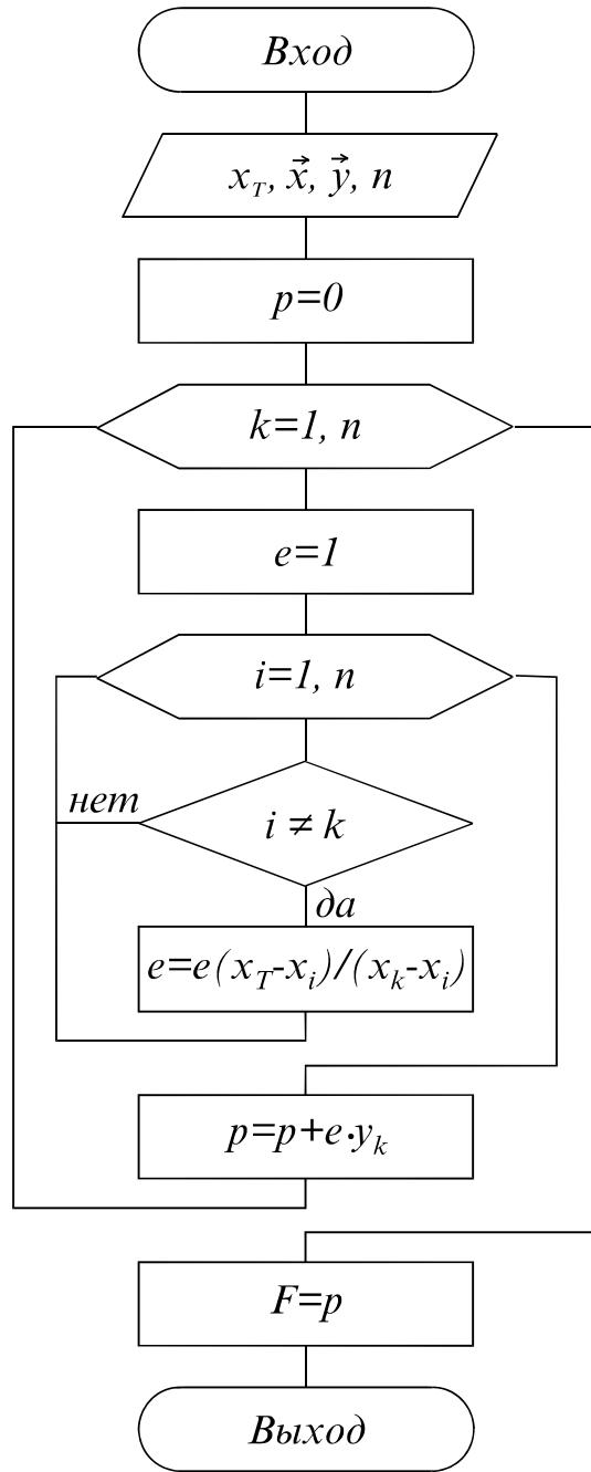
Рис 16.2. Схема алгоритма расчета интерполяционного полинома Лагранжа
