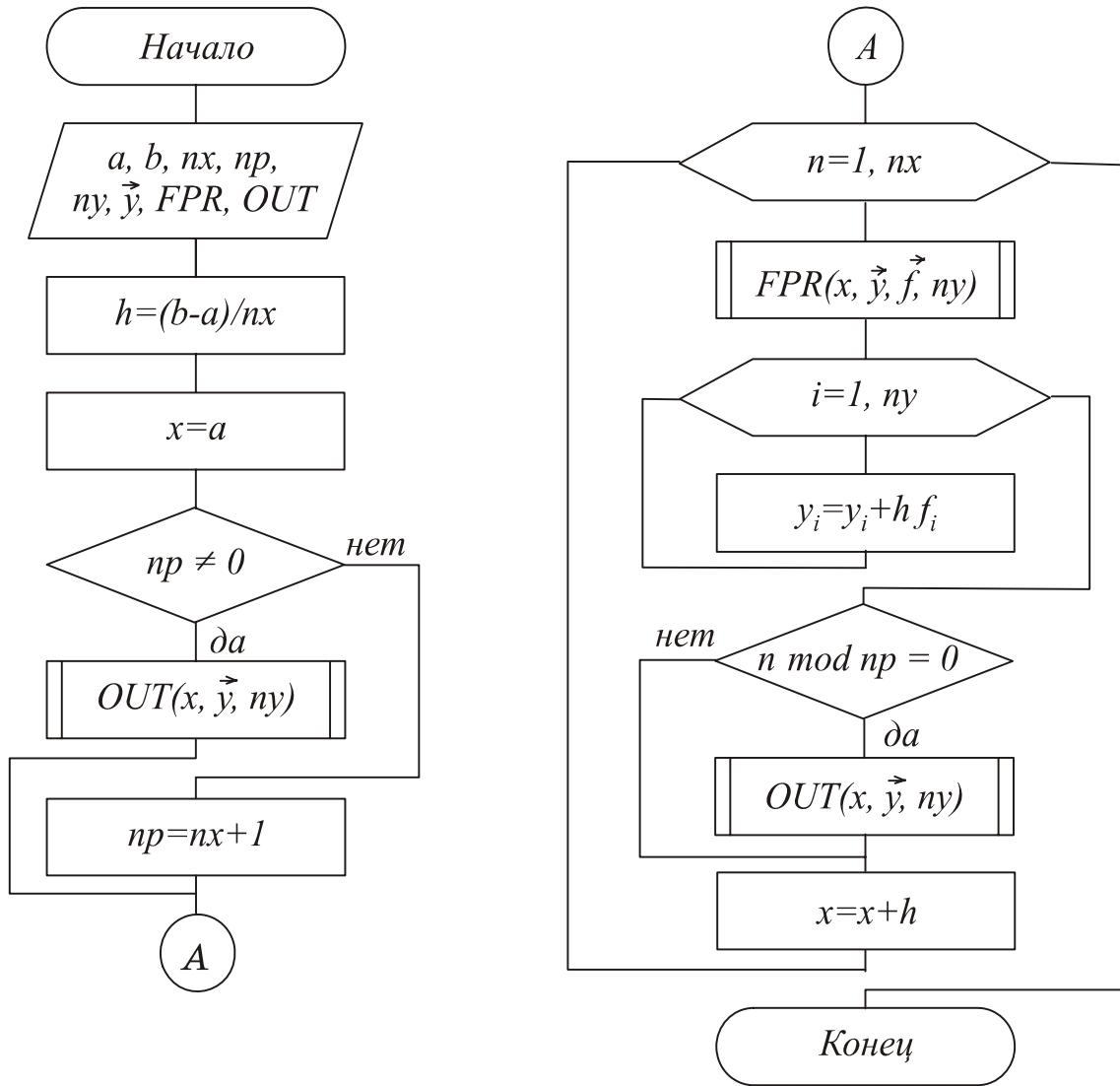
Рис.19.1. Схема алгоритма метода Эйлера
