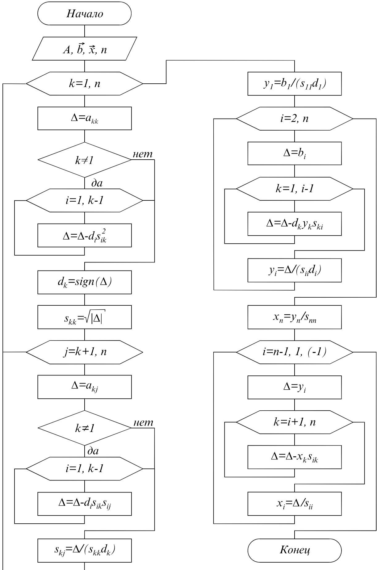
Рис. 15.2 Схема алгоритма метода квадратного корня
