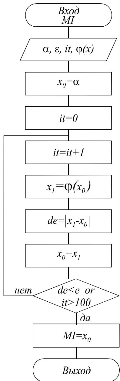
Рис 17.1. Схема алгоритма метода простой итерации
