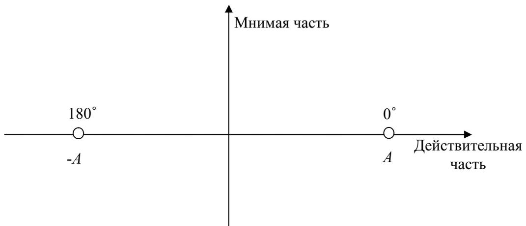
Рис. 1.2. Сигнальное созвездие ФМ-2 сигнала
