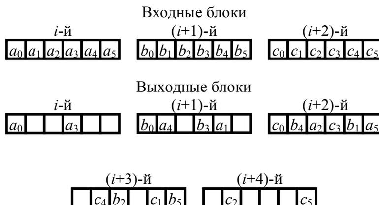
Рис. 5.3. Пример межблочного перемежения при  $B = 3$  и  $N = 2$
