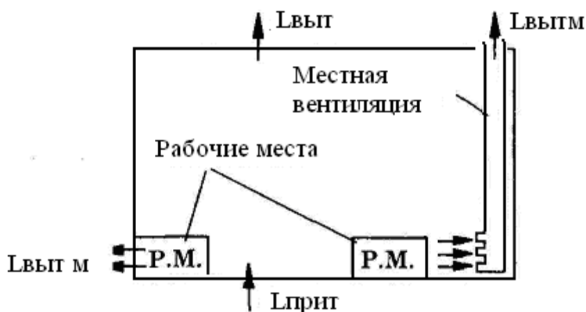
Рис. 3.3. Комбинированная вентиляция помещения: L_{\text{от}} — объем воздуха, удаляемый общеобменной вытяжной вентиляцией, \text{м}^3/\text{ч} ; L_{\text{прит}} — объем приточного воздуха, нагнетаемый общеобменной вентиляцией, \text{м}^3/\text{ч} ; L_{\text{от м}} — удаляемый из помещения воздух за счет местной вытяжной вентиляции, \text{м}^3/\text{ч}
